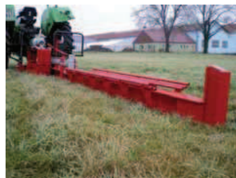
Kliever 25 ton, opening 280 cm, slaglengte van de cilinder 180 cm, aftakas en elektromotor gecombineerd
